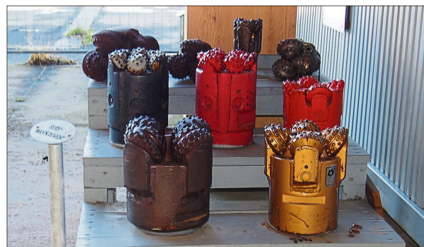
Mit diesen Bohrköpfen wurden die Bohrungen durchgeführt. Sie wurden für Bohrungen in verschiedene Tiefen und Erdschichten verwendet. Während die einen bei der Vorbohrung zum Einsatz kamen, fanden die anderen bei der großen Hauptbohrung Verwendung.
